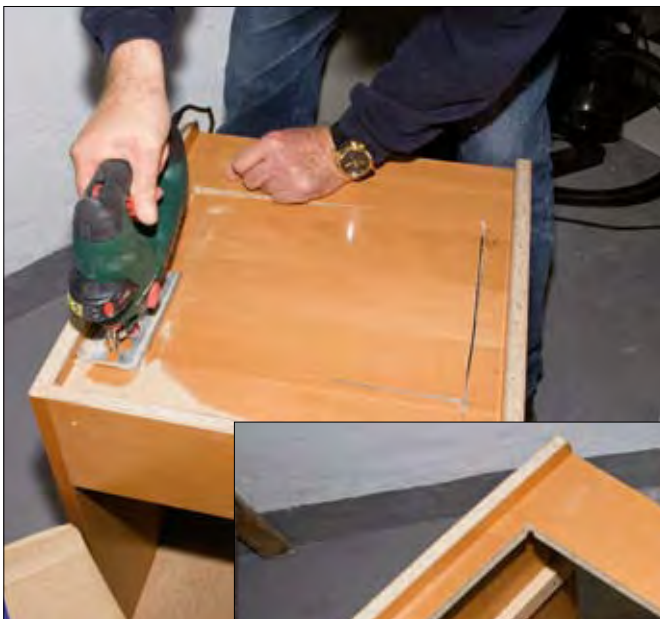
Dank HaJos „Supersäge“ und Erichs ruhiger „Holzwurmhand“ ist der Konsolenausschnitt perfekt gelungen. Der Ausschnitt an der hinteren Oberkante gestattet die Durchführung der Flachbandkabel.
