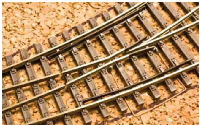
Oben: Mit einer Diamant-Trennscheibe werden die beiden Flügelschienen kurz vor dem Herzstück durchtrennt. Rechts: Die elektrische Verbindung zwischen dem abgetrennten Teil der Flügelschienen und dem Herzstück musste mit Draht wieder hergestellt werden.
