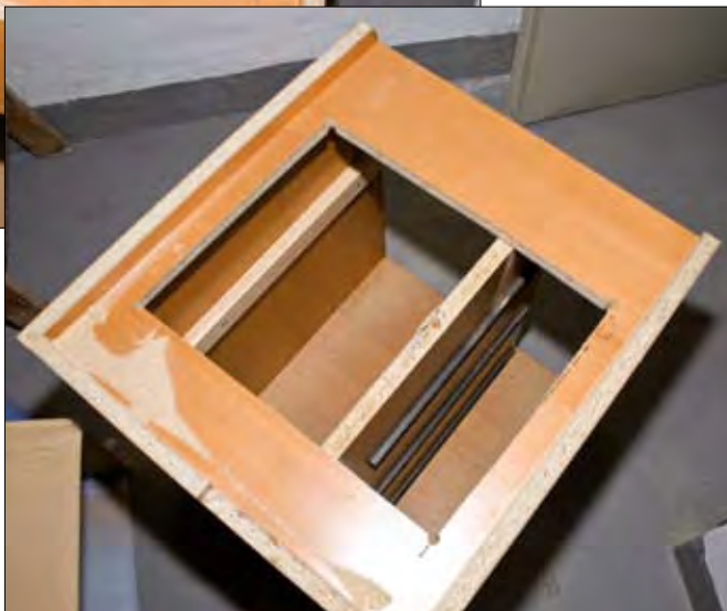
Dank HaJos „Supersäge“ und Erichs ruhiger „Holzwurmhand“ ist der Konsolenausschnitt perfekt gelungen. Der Ausschnitt an der hinteren Oberkante gestattet die Durchführung der Flachbandkabel.
