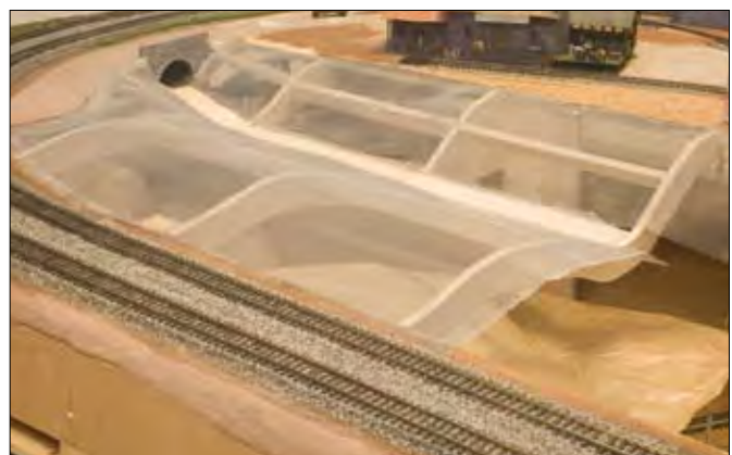
Die Sperrholzspannten haben einen Überzug aus Alu-Drahtgewebe erhalten.
